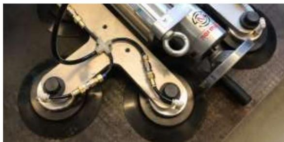
La fresadora portátil Normaco de 3 ejes se suministra de serie con alimentación automática del eje X, pero puede También se entregará sin la función de alimentación automática.
