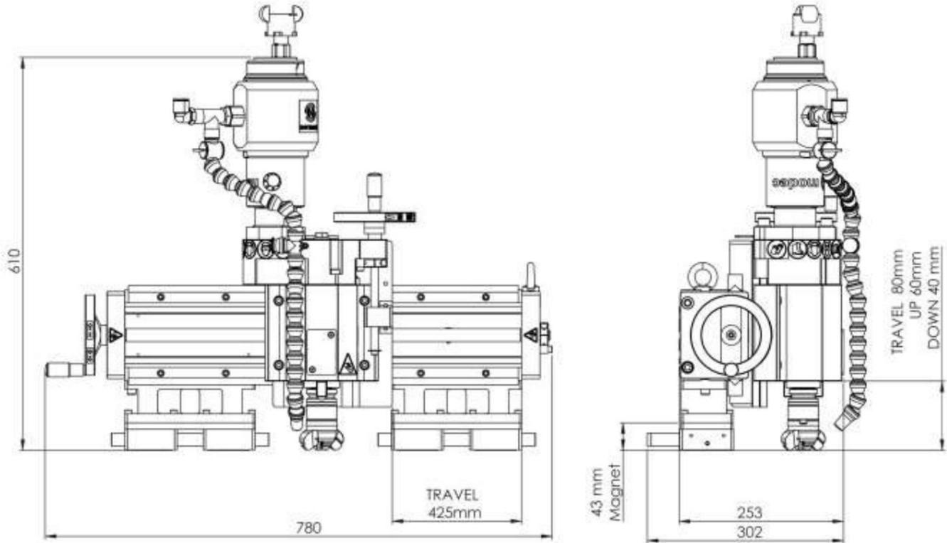
Dimensions de la machine avec avance automatique
